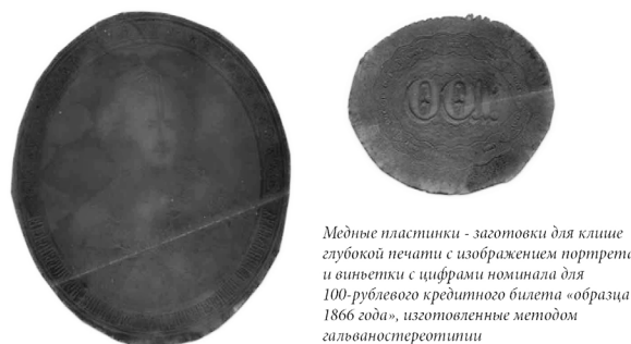
Рис. 5. Заготовка для клише глубокой печати. Pic. 5. Blank for gravure printing cliche.
